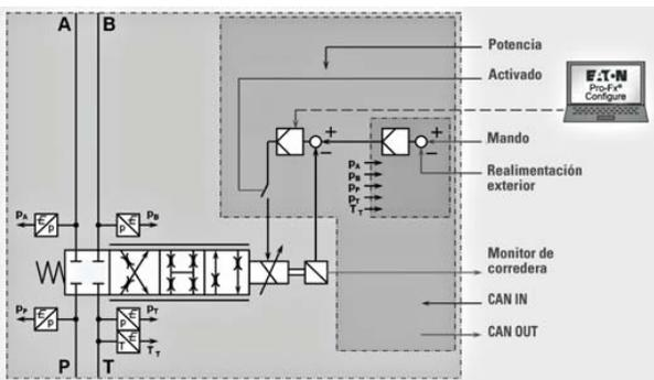
Los sensores de presión integrados de las válvulas de nivel 3 pueden ser utilizados para monitorizar el estado de funcionamiento de la máquina con datos a través del CANopen bus o utilizando control de presión sumado a control de movimiento externo, ilustrado para la válvula de nivel 2.
