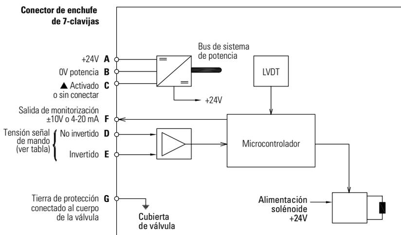
▲ La clavija C es usada para una señal de activación de válvula con conexión eléctrica 6 = H o R.
