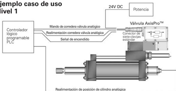
Las válvulas AxisPro de nivel  $\boxed{14}$  = 1, como la KBS1-3 (ISO tamaño 3), pueden ser usadas para el control de movimiento en máquinas en circuitos abiertos o cerrado. La válvula recibe su entrada de mando analógica de las siete clavijas del conector principal del dispositivo de control de eje externo.
