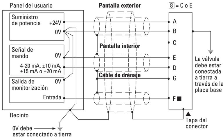
■ La tensión de la corredera (clavija F) será referida a la tierra local de la válvula (Clavija B)..
