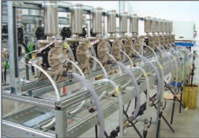
Bombas de membrana de 1/2" montadas en un sistema de formulación de tinta.
