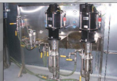
Bombas de pistón de 4 bolas, de relación 4:1, instaladas en un proceso de formulación de pintura.
