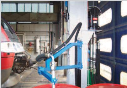
Bombas de pistón de 2 bolas, de relación 9:1, usadas en un proceso de lubricación personalizado.
