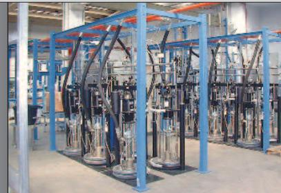
Bombas de extrusión, de relación 13:1, instaladas en un sistema de formulación de tintas offset.
