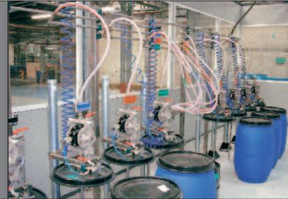
Bombas de membrana de 1/2" instaladas en un proceso de coloración.
