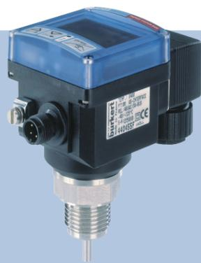
Este sensor / interruptor inteligente con una pantalla especialmente grande está diseñado específicamente para monitorizar valores límite o un lazo de control «on/off» o continuo. Los puntos de conmutación pueden programarse directamente a través de los botones de la pantalla o bien externamente mediante un PLC mediante una entrada de señal estándar de 4-20 mA. Además, el valor de proceso puede transmitirse al PLC mediante una señal de 4-20 mA.
