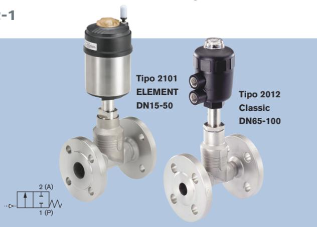
La válvula de globo de pilotaje externo consiste en un actuador de pistón neumático y un cuerpo de válvula de asiento recto de 2 vías. Su doble empaquetadura autoajustable garantiza la integridad del sellado. Estas robustas válvulas, que no necesitan mantenimiento, pueden ser reequipadas con una completa gama de accesorios para la indicación de la posición, la limitación de carrera o el mando manual.
