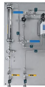
*Estructura de la placa de montaje para el oxígeno*
