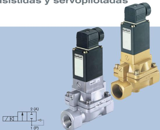
Electroválvula completamente servoasistida servopilotada única con clapeta oscilante. El diseño de esta válvula es mucho menos sensible a la contaminación de los fluidos que el de las válvulas con cierre por núcleo, por lo que ofrece muchas ventajas en el entorno del proceso. El tramo pilotado puede girarse sobre el terreno para convertirla en una válvula normalmente abierta.
