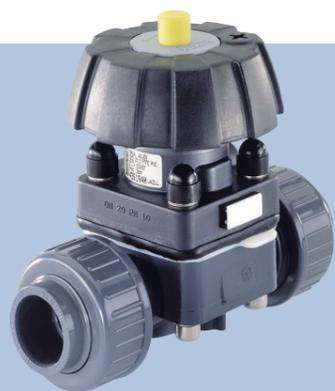
Válvula manual de diafragma para productos químicos agresivos. Proporciona una larga vida útil incluso con fluidos agresivos, sucios o muy viscosos. El diafragma entre el actuador y el cuerpo aísla herméticamente el fluido del actuador y proporciona un resistente sellado sobre el asiento de la válvula. El marco manual ofrece la posibilidad de corte y control de fluido.
