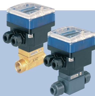
El controlador de lotes 8035 está especialmente diseñado para usarse con líquidos neutros o ligeramente agresivos libres de sólidos. El controlador de lotes consta de un fitting compacto con rueda de paletas (S030) y un módulo electrónico (SE35) que se conectan entre sí de forma sencilla y rápida mediante un sistema de cuarto de vuelta.
