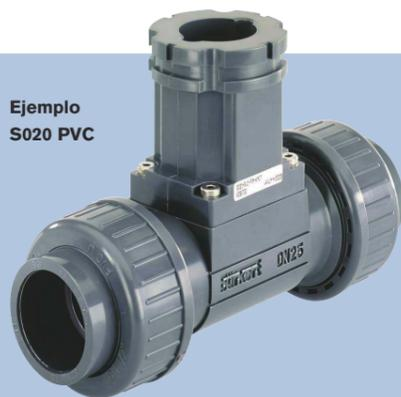
El fitting puede utilizarse para conectar cualquier dispositivo INSERTION para una medición en la tubería, es decir, sensores, indicadores y controladores para la medición de caudal, pH, potencial redox (O.R.P.) y conductividad. El fitting está disponible para caudalímetros con una conexión Clamp o G 2".
