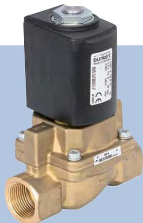
El modelo 6407 es una válvula de pistón servoasistida. El acoplamiento fijo entre la válvula de pilotaje y el pistón hace que la válvula se abra sin que exista presión diferenciada.
