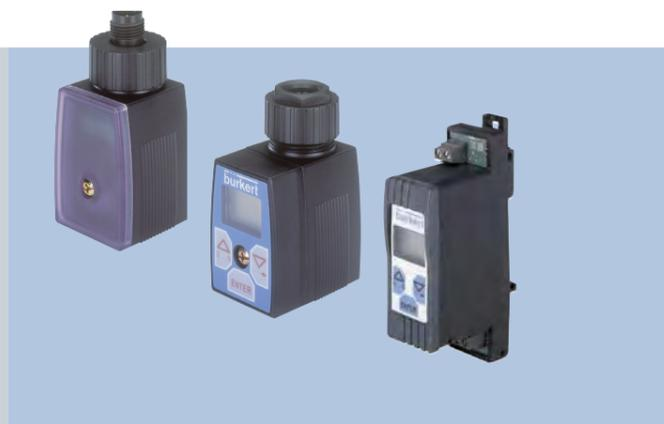
La electrónica de control digital tipo 8605 sirve para trabajar con válvulas dentro del rango de energía de 40 - 2000 mA. La regulación interna de la corriente y la frecuencia de los impulsos PWM como factor de regulación, permiten asignar de forma exacta un valor de corriente de salida a la bobina en función de cada valor de entrada, independientemente del estatus térmico de la bobina.
