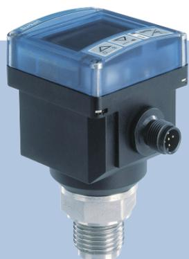
Sensor de presión programable con funciones de conmutación y transmisión. Posee una gran pantalla con un gráfico de barras y controles de menú sencillos. Conexión con el proceso mediante conexiones estándar de acero inoxidable. El valor de proceso puede transmitirse a un PLC mediante una señal de 4-20 mA.
