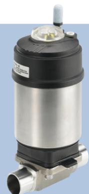
La válvula de diafragma con pilotaje externo tipo 2103 consiste en un actuador de pistón neumático, un diafragma y un cuerpo de válvula de 2 vías de acero forjado. Su actuador de alta calidad con carcasa de acero inoxidable garantiza un uso adecuado en ambientes higiénicos o agresivos. Su válvula optimizada y con volumen muerto igual a cero permite unas velocidades de caudal y una versatilidad elevadas.
