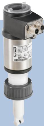
Transmisor de conductividad con salidas programables. Salida de conductividad y temperatura a través de una señal analógica sencilla o dual de 4-20 mA. También se incluyen dos salidas transistor. Los transmisores están diseñados para ofrecer un amplio espectro de rangos de medida, y pueden suministrarse con configuración de 2 o 3 hilos. Su diseño inteligente, integrado y atractivo encaja a la perfección con un surtido de fittings fácilmente configurables.
