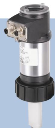
El caudalímetro modelo 8026 genera una salida 4-20 mA directamente proporcional al caudal. La gama de fittings, hace que los transmisores modelo ELEMENT sean perfectos para líquidos neutros y libres de sólidos. Una pantalla extraíble retroiluminada con programación mediante joystick hace que la puesta en marcha sea un juego de niños.
