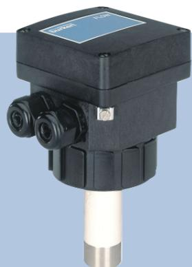
Medidor de caudal electromagnético Insertion, que consta de una sonda de PVDF y un módulo electrónico ciego de alta calidad. Perfecto para fluidos contaminados o agresivos, tiene tanto salida 4-20 mA como de pulsos con relés de 3A opcionales, que hacen de este equipo una solución flexible para el control del caudal o de lotes.
