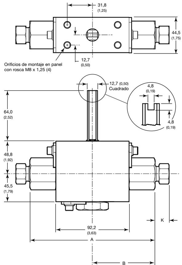
Orificios de montaje en panel con rosca M8 x 1,25 (4)
