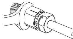
Alternativamente, sujete firmemente el cuerpo del accesorio y apriete la tuerca hasta el par especificado.
