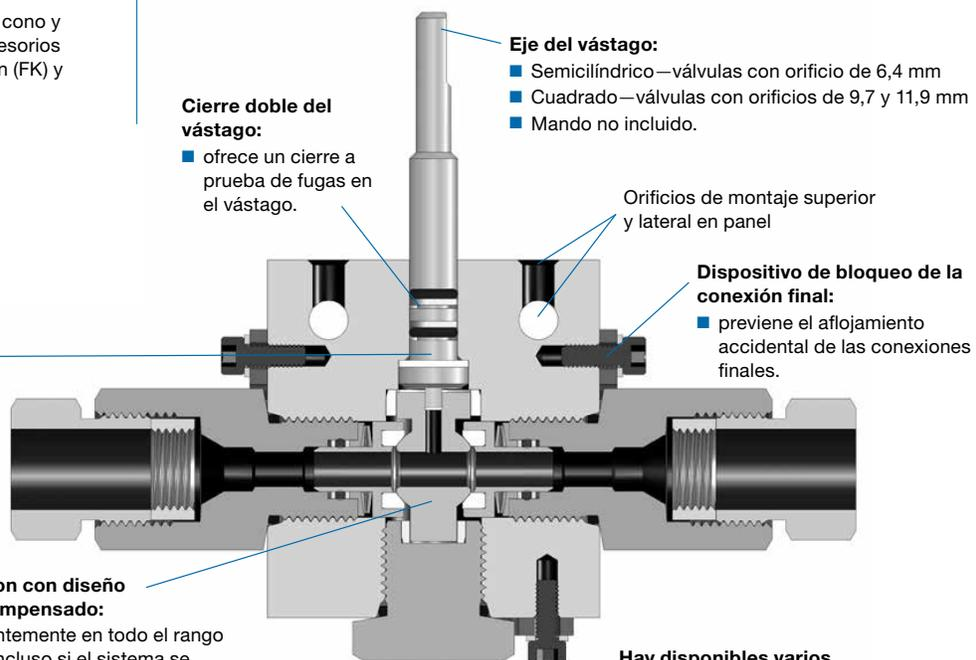
Se muestra: válvula con orificio de 6,4 mm.
