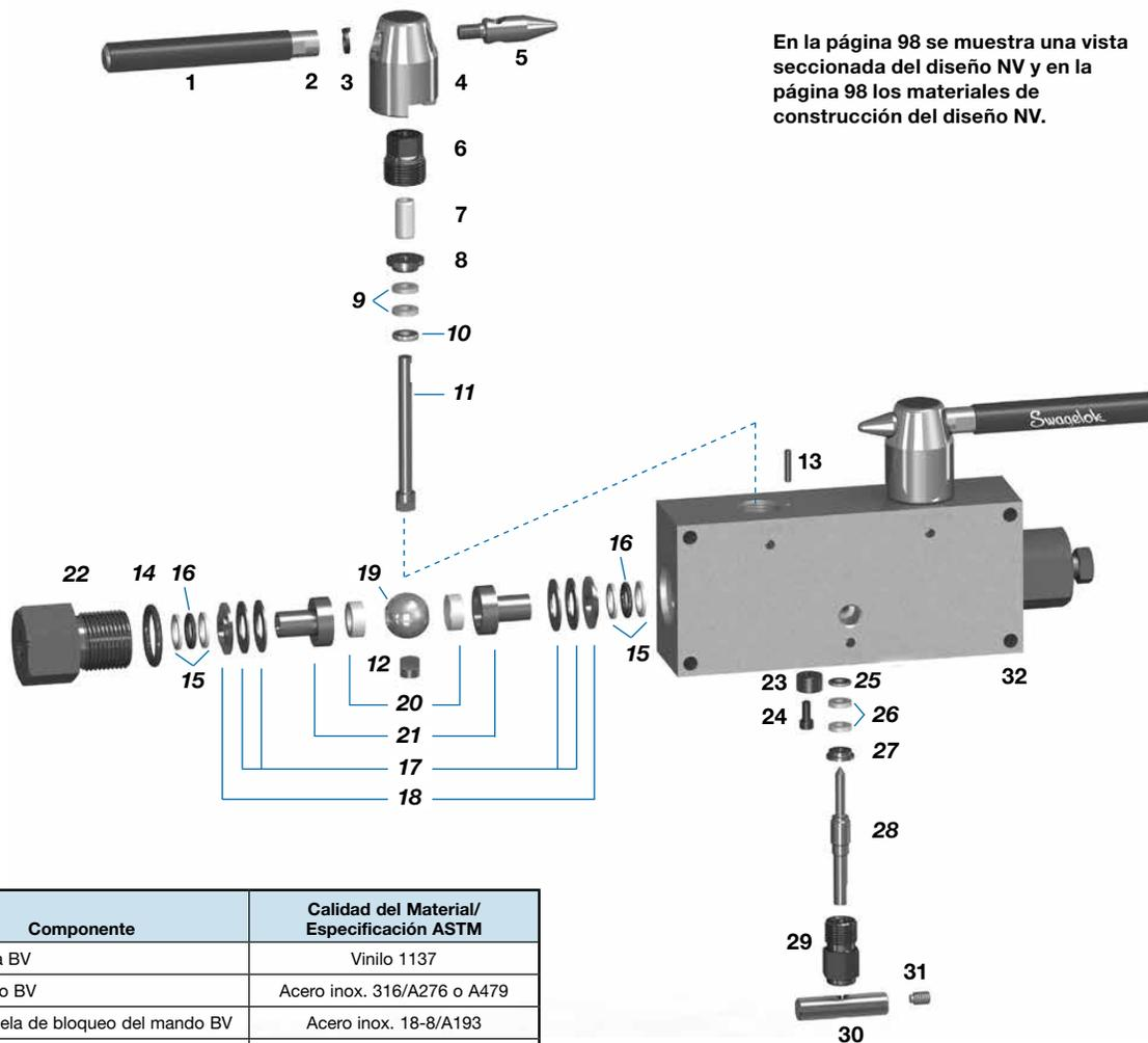
En la página 98 se muestra una vista seccionada del diseño NV y en la página 98 los materiales de construcción del diseño NV.
