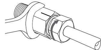
5. Sujete firmemente el cuerpo del accesorio y apriete la tuerca 1/3 de vuelta (Fig. 3). Eso equivale a girar la tuerca dos hexágonos desde la marca. Alternativamente, sujete firmemente el cuerpo del accesorio y apriete la tuerca hasta el par especificado.
