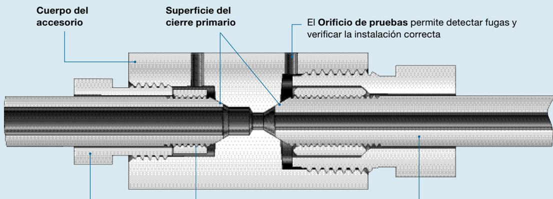
El **manguito** crea una carga sobre el collarín para asegurar el cierre entre el tubo y el área del ángulo del cuerpo.
