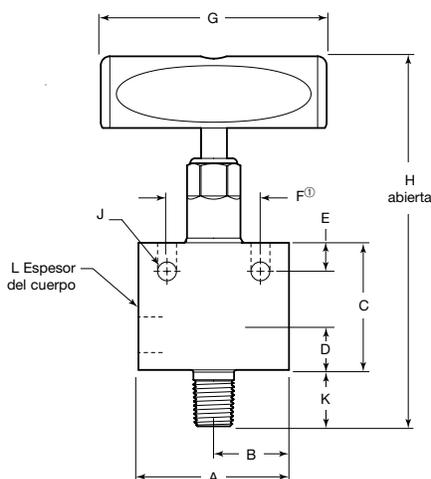
① Orificios de montaje en panel
