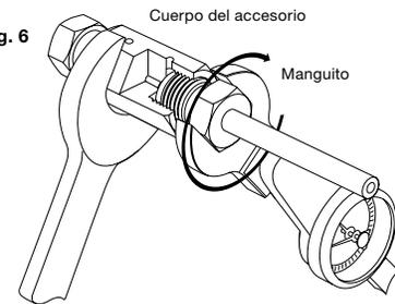
1. Lubrique todas las roscas macho con un lubricante antiagarrotamiento como el lubricante Goop Swagelok. Lubrique el extremo cónico del tubo con un lubricante compatible con el sistema.
