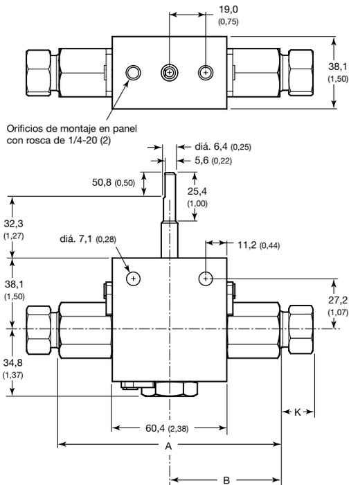
Orificios de montaje en panel con rosca de 1/4-20 (2)
