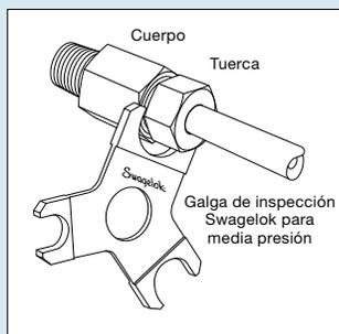
En la instalación inicial, la **galga de inspección Swagelok para media presión** asegura al instalador o al inspector que los accesorios están suficientemente apretados.
