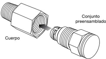
1. Rosque el conjunto preensamblado (tuerca, férulas y dispensador de plástico) en el cuerpo del accesorio y apriételo a mano (Fig. 1).
