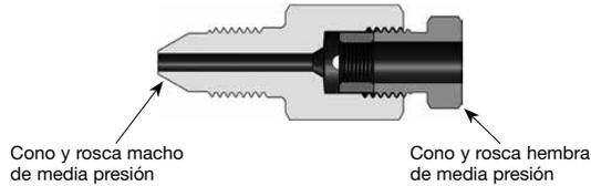
Arriba se muestra una conexión de una pieza con cono y rosca.
