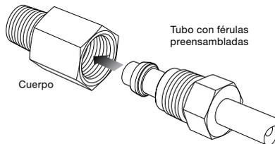
1. Preinstale las férulas sobre el tubo con la Unidad hidráulica de deformación con matrices intercambiables Swagelok (MHSU) y las herramientas de media presión adecuadas.
